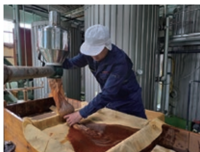
槽掛け(ふねかけ)工程
